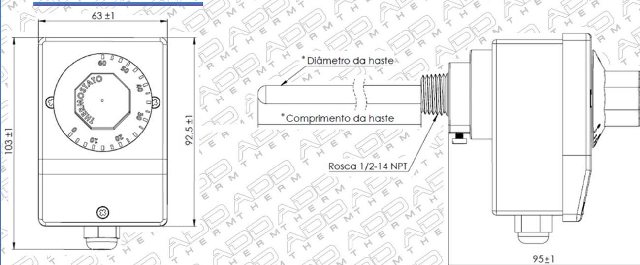
\*Diâmetro da haste: Customizável conforme a necessidade do cliente
